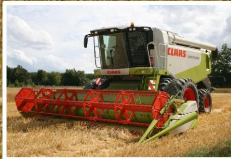
**La moissonneuse-batteuse** coupe et aspire les tiges des céréales. Les tiges sont séparées des grains. Les grains arrivent dans la remorque et les tiges sont rejetées à l'arrière.
