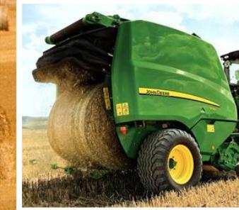
**La ramasseuse-presse** ramasse la paille (les tiges de céréales coupées et battues) et la comprime en balles.
